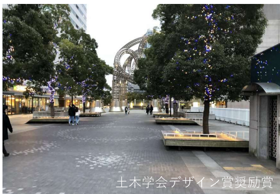
根上がり防止に配慮した例-1 (横浜市 グランモール公園)
