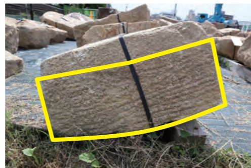
写真2 ノミで加工された側面
