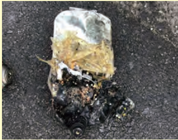
火災原因と思われる灯油タンク
