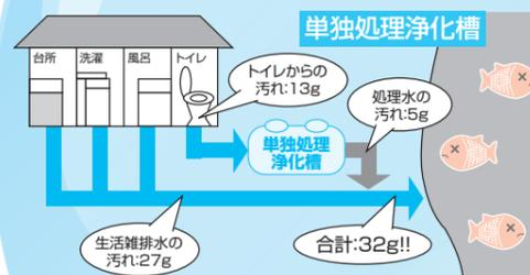
合併処理浄化槽に入れ替えると、河川の水質に与える影響を約8分の1に減らすことができます。
