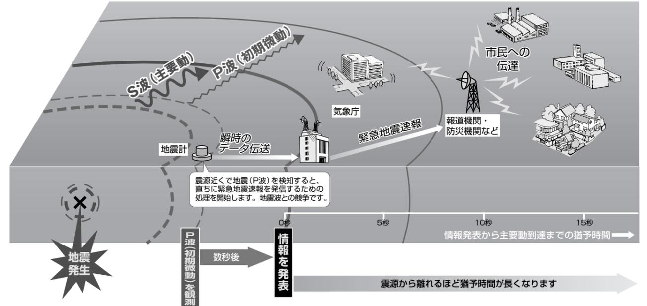
「緊急地震速報」は、震源近くで地震（P波：初期微動）をキャッチし、位置、規模、想定される揺れの強さを自動計算します。地震による強い揺れ（S波：主要動）が始まる数秒～数十秒前に、素早くお知らせします。ただし、震源に近い地域では、「緊急地震速報」が強い揺れに間に合わないことがあります。
