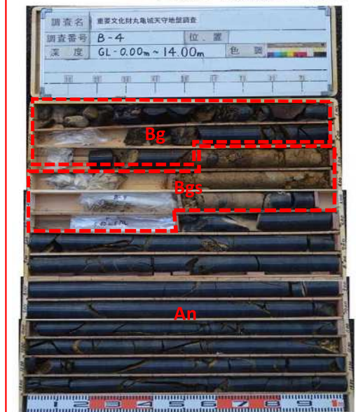
コア写真(No. B-4 地点: 深度 0.00~14.00m)
