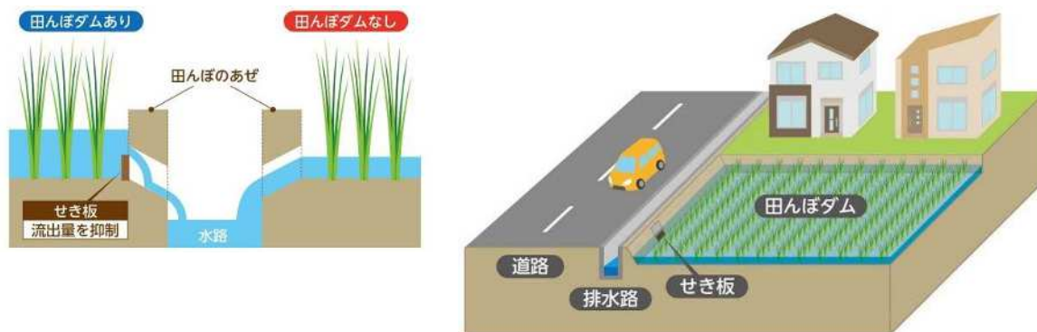
図 5.1.4 田んぼダムによる流出抑制対策のイメージ
