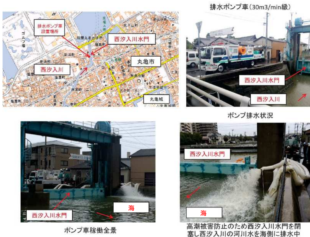
図 7.3.4 国土交通省の排水ポンプ車による排水支援
