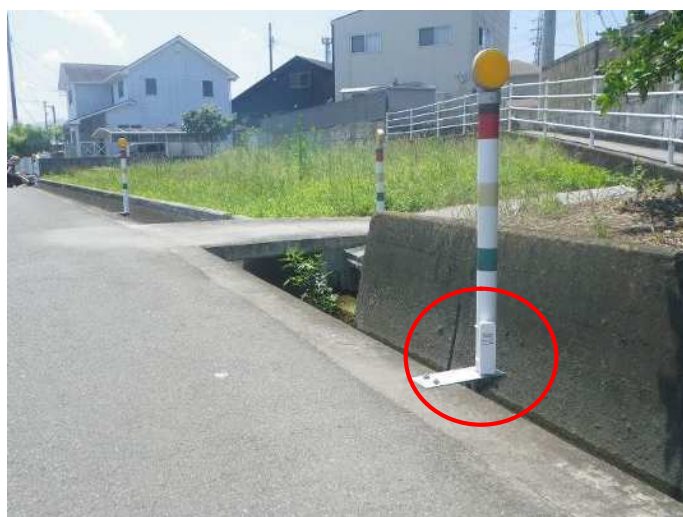
図 7.3.2 ワンコイン浸水センサ実証実験（設置例）
