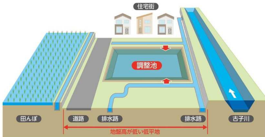
図 5.1.3 調整池による流出抑制対策のイメージ
