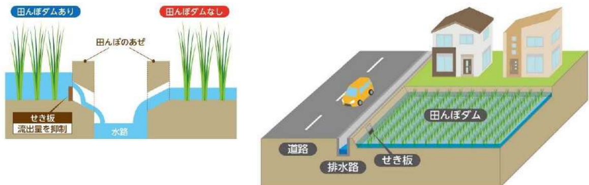
図 5.3.3 田んぼダムによる流出抑制対策のイメージ
