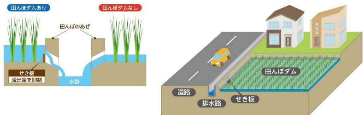
図 5.2.7 田んぼダムによる流出抑制対策のイメージ
