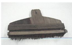
筋入機 うちわの骨筋をたてる。
