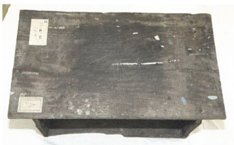
貼り台 作業台。 (貼り作業全般に用いる。)
