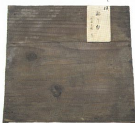
糊板 うちわ骨に糊を付ける時に使う板。
