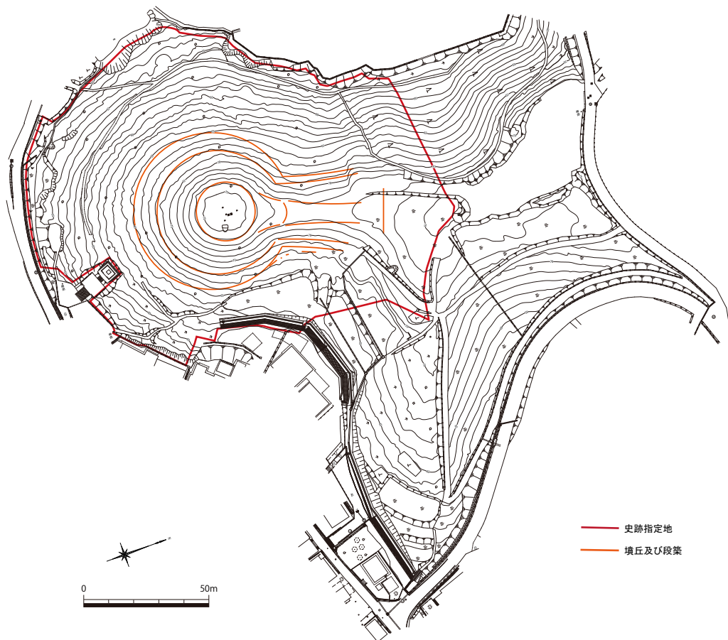
図 24 墳丘養生完了・法面擁壁工事完了図（令和元年度（2019）作成）
